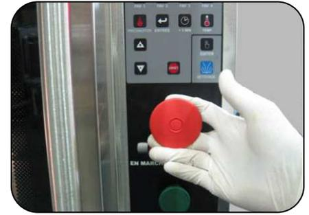
3. Vérifiez que l'alimentation et la valve des gaz sont ouvertes. Repartir le four en tirant sur le bouton rouge. Si le four ne repart pas, appuyer sur le bouton rouge pour le fermer.
