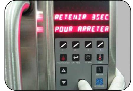
3. Appuyer sur la touche "**ARRET**" durant 3 secondes jusqu'à ce que le panneau indique: "PRECHAUFFER OU NETTOYAGE". Appuyer sur **PRECHAUFFER** pour repartir le four.
