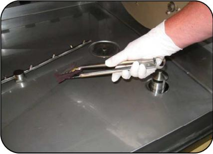
4. Enlever tous les débris et morceaux accumulés au fond du bassin et les jeter à la poubelle. **NE PAS POUSSER LES DÉBRIS DANS LES DRAINS!**
