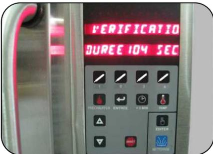
8. L'affichage indiquera "VERIFICATION DE LA TEMP..." lorsque que le cycle d'auto nettoyage commence. Lorsque que le cycle est complet, la machine s'arrêtera d'elle-même.
