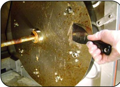
5. (Si nécessaire) Utilisant un grattoir, s'assurer d'enlever le plus de carbone possible sur les plaques de conduites et l'axe pendant que le four est tiède.
