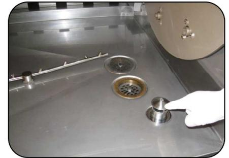
9. Lorsque la flamme est visible, remplir le bassin d'eau jusqu'à ce que le niveau d'eau atteigne le trop-plein puis fermer la valve d'eau.
