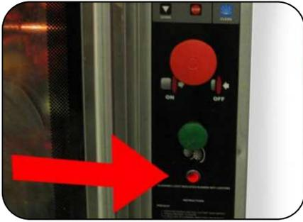
1. Si l'interrupteur principal (bouton rouge) est tiré et que l'allumeur est rouge après plusieurs essais et qu'il n'y a pas de flamme, le dispositif anti-allumage de sécurité est activé. Le témoin lumineux clignotera.
