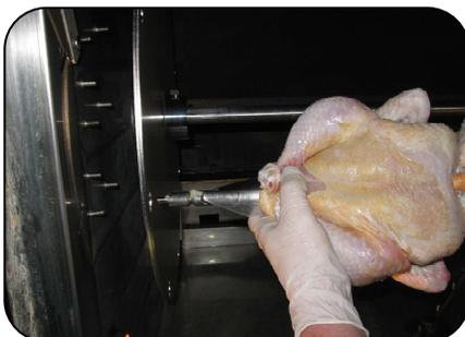
2. Pour charger les broches dans le four, insérez le bout pointu dans le trou rond du côté gauche.
