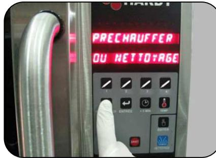
8. Le bassin du four doit être sec avant de réchauffer le four. Appuyer sur la touche "PRECHAUFFER" **Attendre que le four soit réchauffé avant de charger (poulets).**
